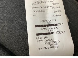
Elektrik donanımı/Pano, Akü > Test Sonucu
